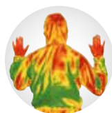
Herkömmlicher Schutzanzug nach 10 Minuten körperlich anstrengender Arbeit.
