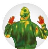
KLEENGUARD® A45 Der Temperaturanstieg ist weitaus geringer und viel gleichmäßiger verteilt. Die körperliche Belastung für die Person ist wesentlich geringer.
